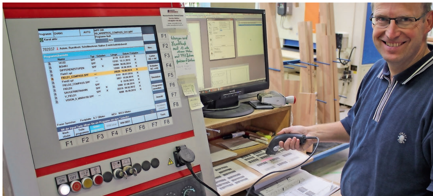
Die Barcode-Erkennung der zu fertigenden Teile über das Modul »Table« der Treppenbausoftware
