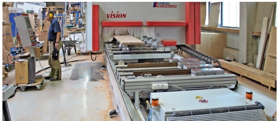
Hightech in der Werkstatt: BAZ mit Fünfkopfkopf und Spindeldrehzahlen bis zu 24 000 min -1
